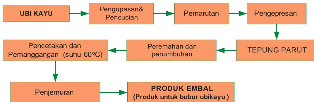
**Gambar 10.** Proses Pembuatan Produk Embal
