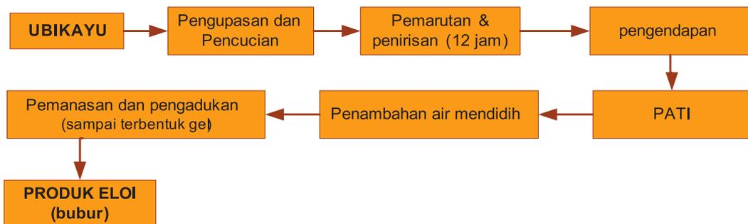
**Gambar 5.** Proses Pembuatan Makanan Eloi
